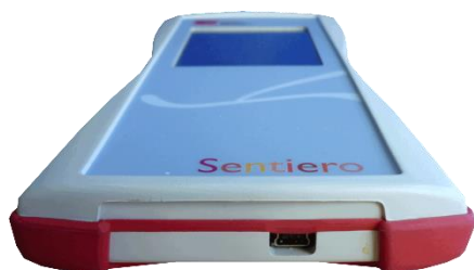
Рисунок 5: Разъем USB для портативного устройства
