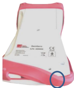
Рисунок 3: Кнопка перезагрузки на портативном устройстве.
