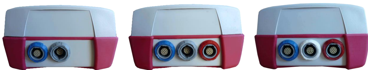
Рисунок 4: Панель разъемов портативных устройств (слева направо: Senti, Sentiero, Sentiero Advanced)
