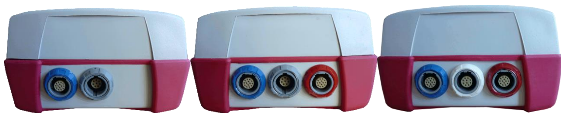
Сурет 4: Тасымалданатын құрылғылардың жалғағыштар панелі (солдан оңға қарай: Sentio, Sentiero, Sentiero Advanced)
