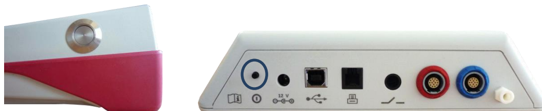
Сурет 2: Аспаптың тасымалданатын (сол жақта) және үстел үстіне қойылатын(оң жақта, көк түспен белгіленген) нұсқаларындағы қосу/ажырату батырмасы.
