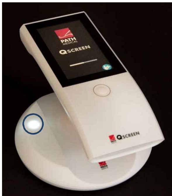
Сурет 5: Базалық станциядағы қуат берудің белгі беру шамы
